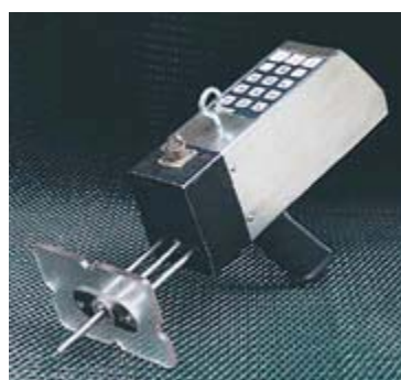
Photo 22 : Le PG-100 Pork Grader (Source : Anitech)
